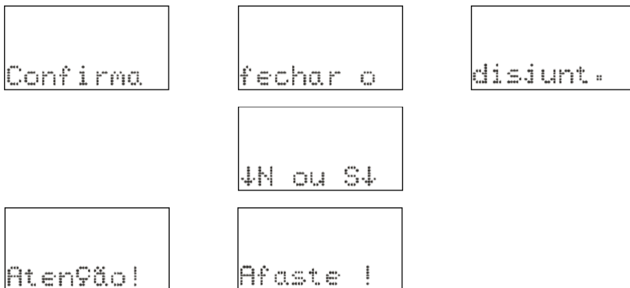
Figura 3.10: Comando local para fechar o disjuntor.
