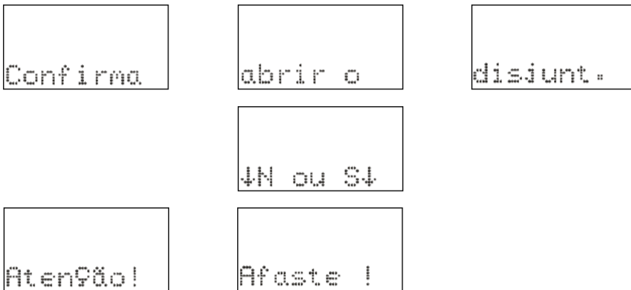
Figura 3.12: Comando local para abrir o disjuntor.
