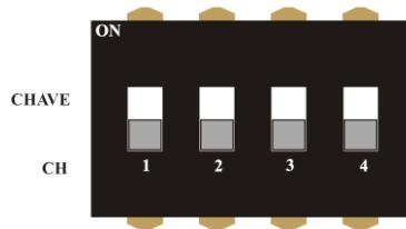
1 – a chave dip interna CH posição 4 em **OFF** desabilita a programação do relé através do teclado.
