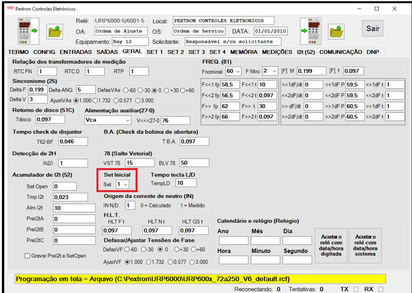
Figura 22.3: Sinalização do aplicativo pasta GERAL para alteração de set ativo de programação.
