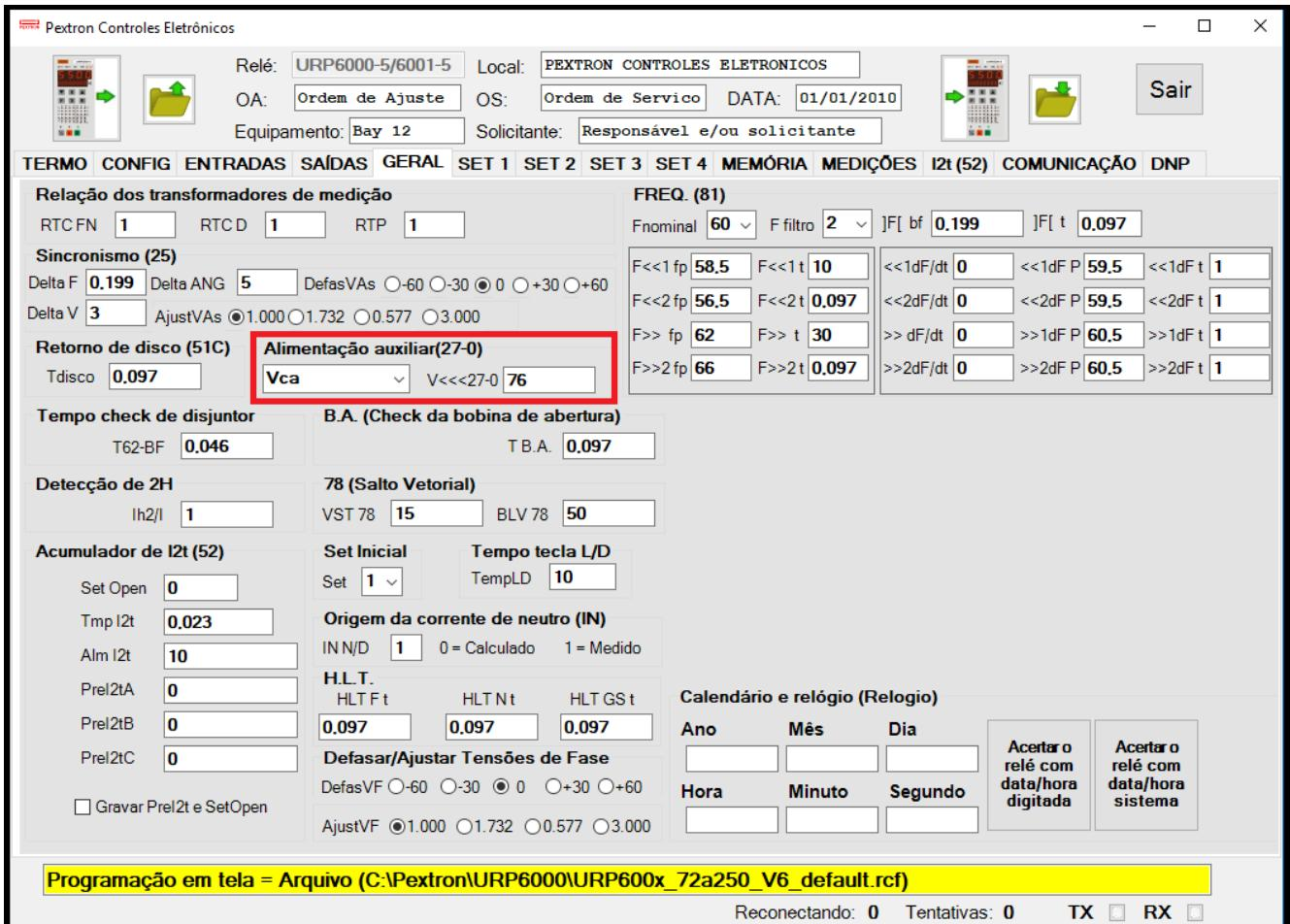
Figura 9.9: Pasta GERAL sinalizado com os parâmetros da unidade de subtensão da alimentação auxiliar.
