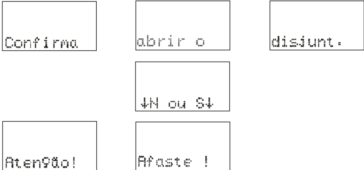
Figura 3.12: Comando local para abrir o disjuntor.
